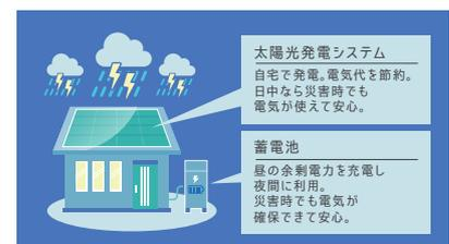
停電が長期化する災害時でも、太陽光パネルと蓄電池があれば、日中でも、夜間でも電気が使えます。万が一の災害時にも安心です。
